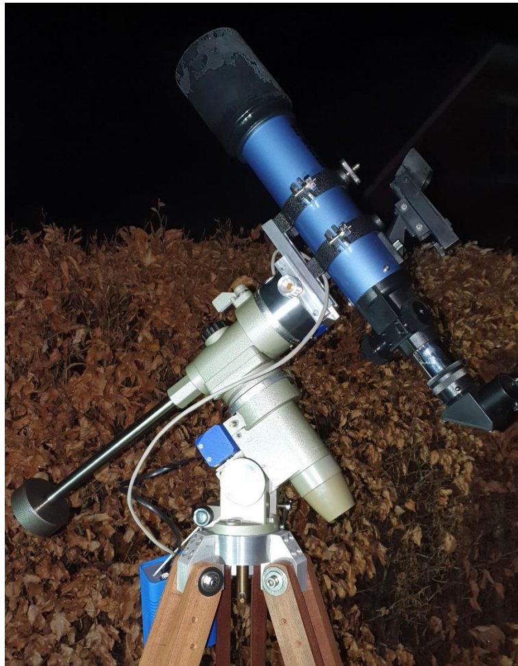
Abbildung 1: Super Polaris Montierung mit 70mm Refraktor in CWD-Position.
